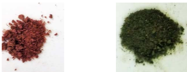
Рисунок 114. Фотографии гибридного материала 2H-12d@70TiO 2 : свеже-приготовленный порошок (слева); порошок после нахождения в течение 5 часов на воздухе (справа).
