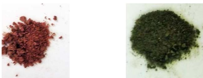
**Рисунок 114.** Фотографии гибридного материала **2H-12d@70TiO<sub>2</sub>**: свежеприготовленный порошок (слева); порошок после нахождения в течение 5 часов на воздухе (справа).
