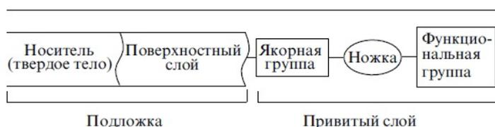
**Рисунок 43.** Строение поверхности при химическом модифицировании.
