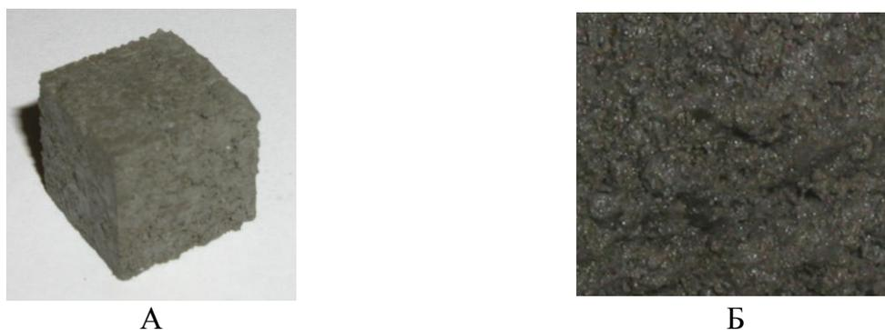
Рис. 3.18 – Внешний вид (А) и внутренняя структура (Б) цементного образца с маслом и аэросилом
