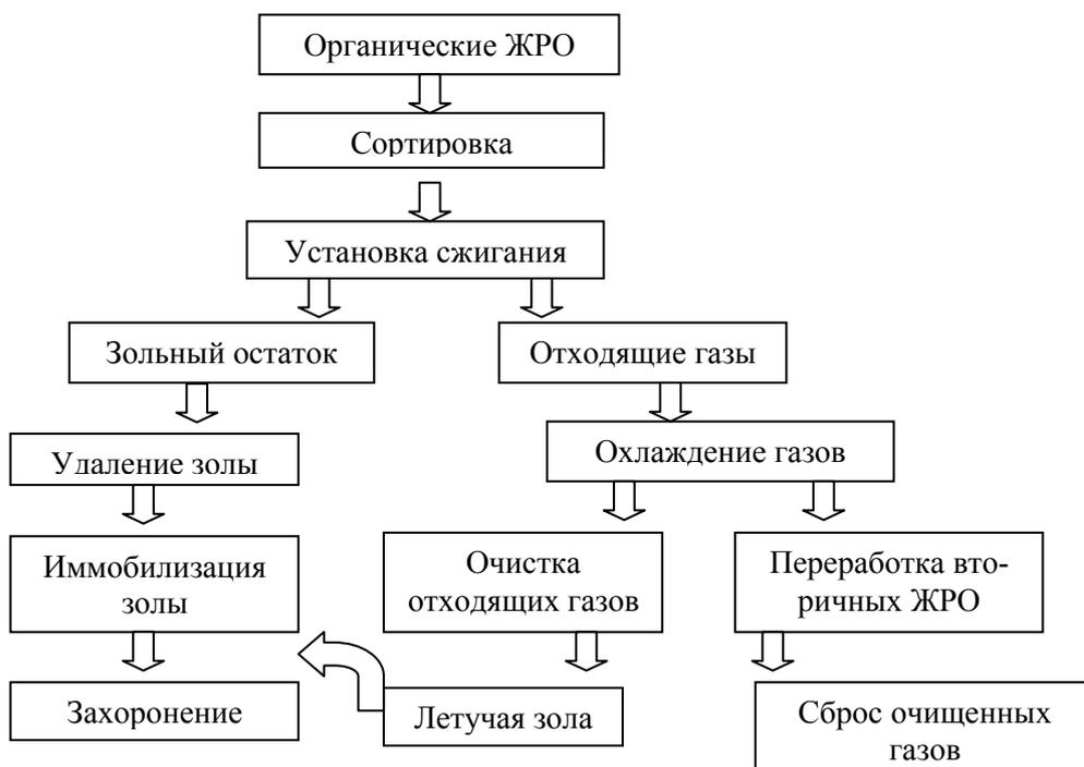
Рис. 1.2 – Схема переработки ОЖРО методом сжигания
