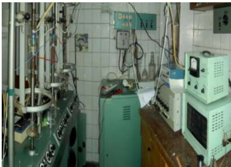
Рисунок 2. Общий вид разрывной машины для статических испытаний и установки для измерения скорости роста трещины
