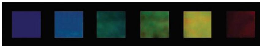
**Рис. 6** Изменения цвета плёнки, содержащей в своём составе однонаправленный молекулярный ротор.
