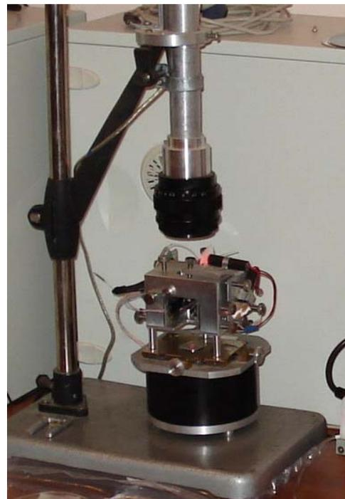
Рис.1 Атомно-силовой интерференционный микроскоп
