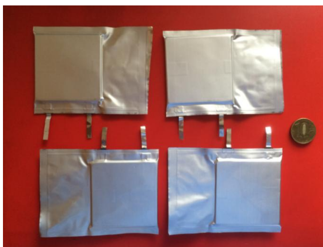
Рис. 4.2. Фотографическое изображение экспериментальных образцов аккумуляторов с «карманом» для сбора газа.
