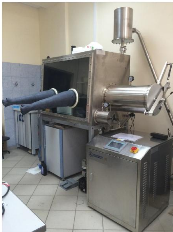
Рис.2.1. Фотографическое изображение перчаточного герметичного бокса с системой регенерации сухого аргона
