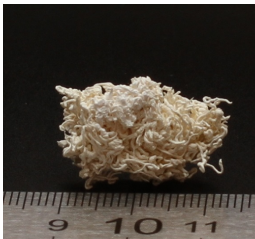
Рис. 1. Внешний вид материала после спекания ( t = 1400 \text{ }^\circ\text{C} )
