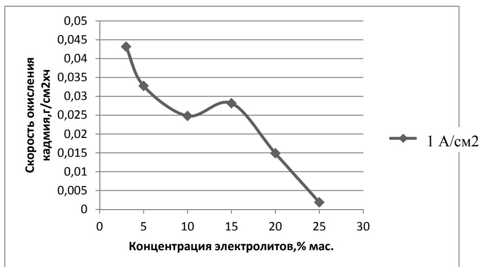
Рисунок 1 – Зависимость скорости разрушения кадмия от концентрации электролита
