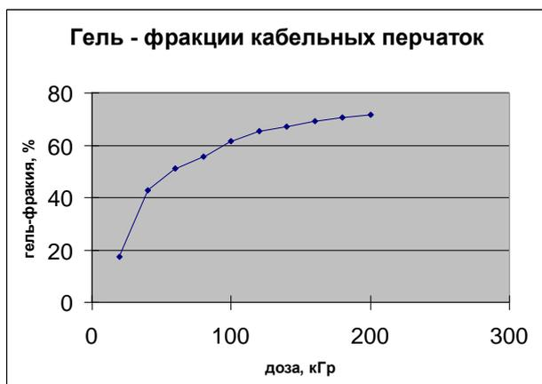
*Рис. 4. Зависимость гель-фракции термоусаживаемых изделий от дозы*
