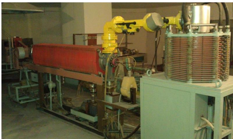
*Рис. 14. Ускоритель типа "Электроника"- энергия 8,5 МэВ, мощность в пучке 20 кВт*
