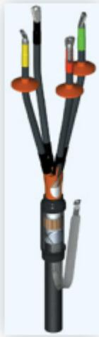
*Рис. 6. Концевые термоусаживаемые муфты наружной и внутренней установки предназначены для оконцевания трех и четырех жильных силовых кабелей на напряжение до 10 кВ. Устанавливаются на открытом воздухе и в помещении, в том числе в качестве мачтовых. Диапазон допустимых температур окружающей среды от  $-50^{\circ}$  до  $+50^{\circ}\text{C}$ , а также при относительной влажности до 98% и температуре до  $35^{\circ}\text{C}$*
