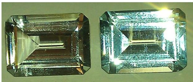
*Рис. 3. Электронно-лучевая модификация топазов при разных дозах облучения*
