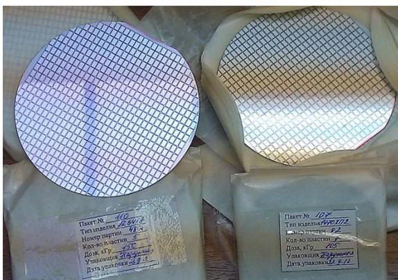
*Рис. 1. Кремниевые полупроводниковые пластины с заготовками приборов после электронно-лучевой обработки*
